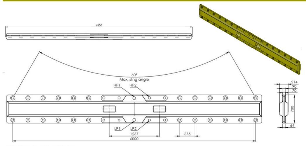
Lifting Beam Koppelbaar 50T - 6m Type: EVK5060.02.01 Weight: 1937 KG WLL: 50T
